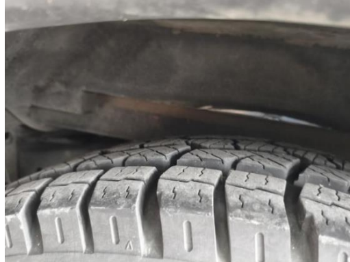
Imagen 18. Punto de desgaste rose llanta [Fotografía]
